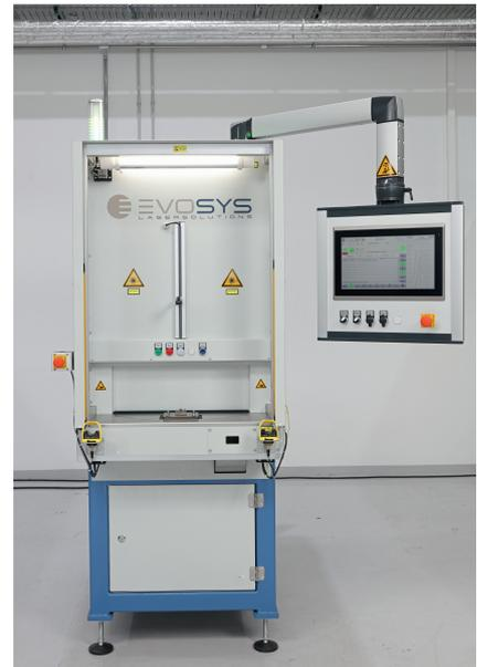
Der Diodenlaser der EVO 1800 fügt die Teile per Konturschweißen – in zwölf Sekunden pro Helm. © Evosys
